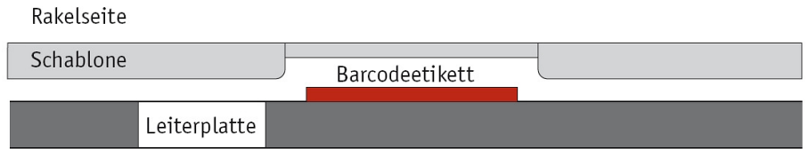
Bild 2: Step-down-Schablone mit Aussparung auf der Unterseite
