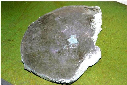
.... soit les barres moulées après la révision du pot d'étain, ainsi que le fil à souder ou les résidus de la pâte à braser sont collectés et recyclés à l'usine.
