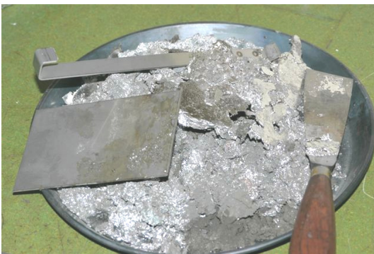
Soit les scories de la soudeuse à la vague .....
