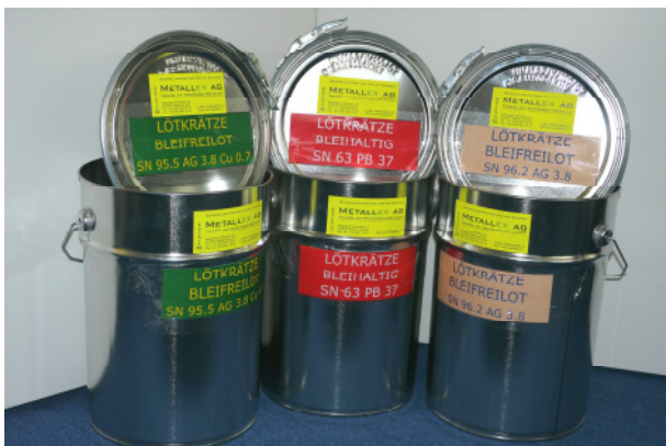
Seaux de scories avec la désignation de l'alliage et couvercles (fer-blanc)
